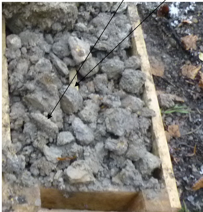
Obrázek 11: Foto jádra – kusovitě rozpadavé břidlice a křemence (hl. 5,0–5,4 m)
