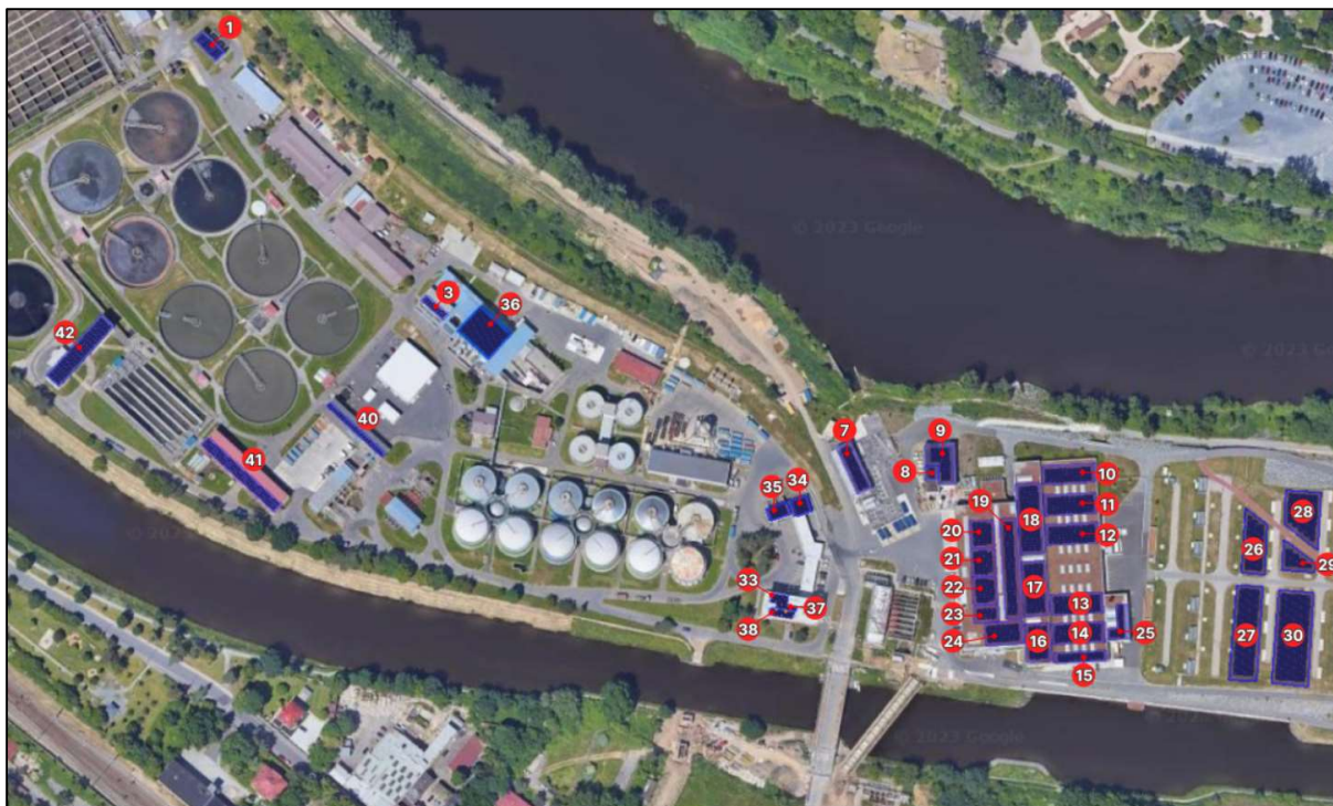
Obrázek 28 – Místa vytipovaná pro umístění fotovoltaických panelů – 1.Etapa – var.A
